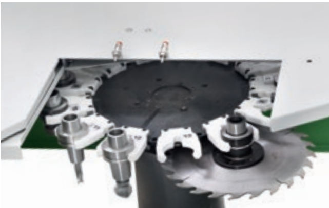
Revolver-Werkzeugmagazin mit 13/16 Plätzen.
