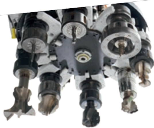
Revolver-Werkzeugmagazin mit 8 Plätzen.
