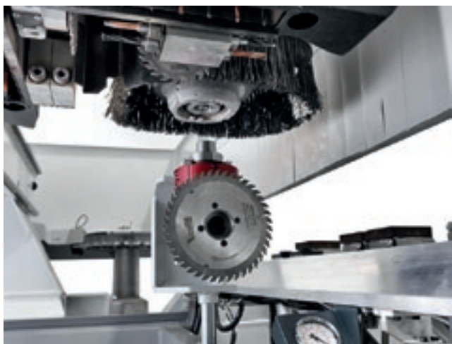
Der Pick Up Wechsler gestattet die Bestückung der Magazine in der Maschine.
